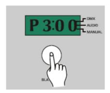
Drücken Sie die Black-out-Taste, bis die Record LED's ausgehen. Dadurch ist die Aufnahme beendet.
