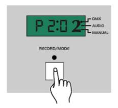
Erstellen Sie an Ihrem DMX Controller eine neue Szene. Drücken Sie die Record-Taste, um die Szene zu ändern. Dadurch ist die alte Szene durch die neue ersetzt worden.
