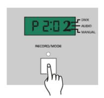
Drücken Sie die Mode Taste mehrmals bis die LED bei Manual leuchtet.
