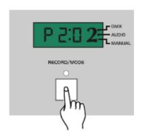
Drücken Sie die Mode- Taste solange bis die LED bei Audio leuchtet.
