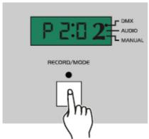
Erstellen Sie an Ihrem DMX Controller eine neue Szene. Drücken Sie die Record-Taste. Dadurch haben Sie die Szene dem Programm hinzugefügt.
