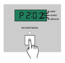
Drücken Sie solange die Mode Taste, bis die beiden LED's (Audio, Manual) ausgehen. Nun befinden Sie sich im Auto- Modus.
