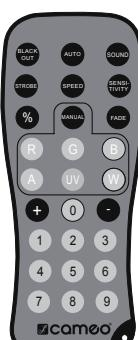
**Pilot na podczerwień skierować bezpośrednio w stronę czujnika podczerwieni znajdującego się na przednim panelu reflektora. Maksymalny zasięg wynosi ok. 8 metrów. W trybie pracy DMX i Slave funkcje pilota są nieaktywne. Bateria do pilota na podczerwień = CR2025.**
