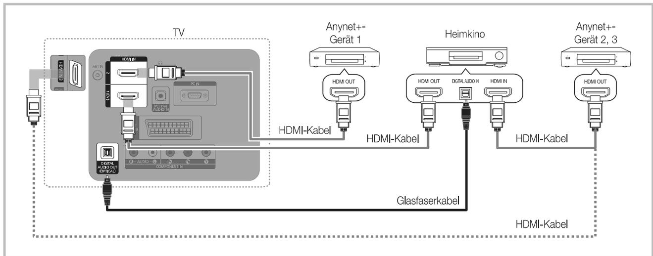
1. Verbinden Sie einen der Anschlüsse **HDMI IN (1(DVI), 2 oder 3)** am Fernsehgerät mit dem **HDMI OUT**-Anschluss am entsprechenden Anynet+-Gerät. Verwenden Sie hierfür ein **HDMI-Kabel**.
