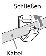
Wenn Sie das Kabel aus dem Halter lösen möchten, drehen Sie es zunächst, um den HDMI-Kabelhalter zu entsperren.
