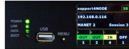
Den Button MENU solange gedrückt halten bis das gewünschte Menü öffnet. Den Button loslassen, wenn in einem Menü eine Einstellung vorgenommen werden soll. Zum Ändern einer Einstellen den Menü-Button kurz drücken, die neue Einstellung ist farbig gekennzeichnet. Nach kurzer Zeit springt die Anzeige wieder auf das erste Menü zurück.
