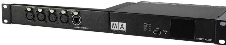
4 DMX – OUT (XLR 5 pin) an der Rückseite. Die DMX OUTs können auch zu DMX IN konfiguriert werden
